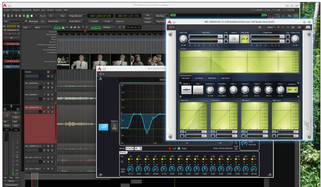
12 Der 16-Band-LSP-Equalizer (links hinten) lässt sich intuitiv bedienen. Das Multiband-Gate von CALF daneben erlaubt es, lediglich den Bass-Bereich mit dem Gate zu bändigen.
