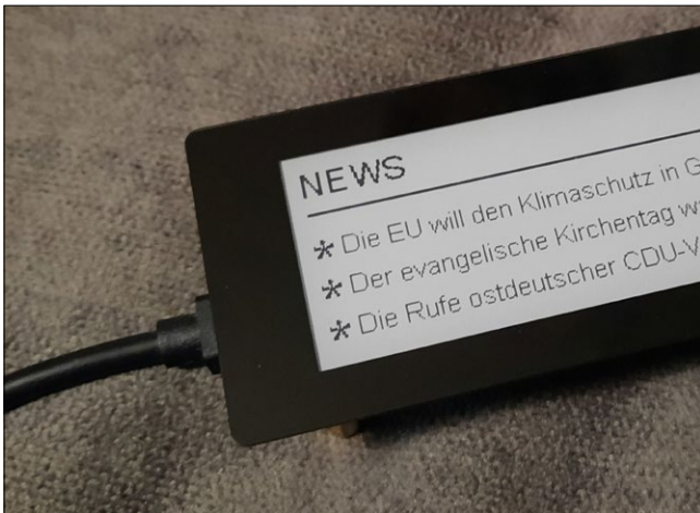
4 Das ePaper-Display zieht nur beim Anzeigewechsel Energie.
