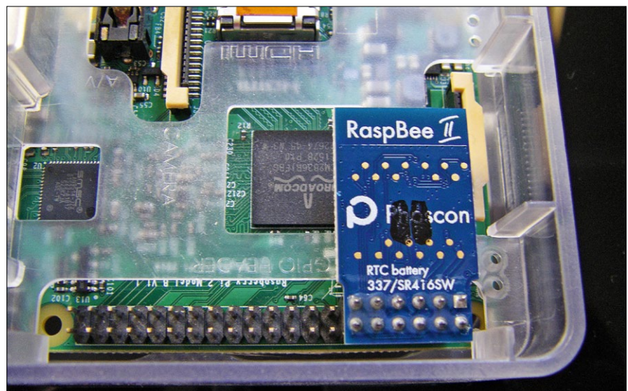
2 Das Zigbee-II-Modul wird am Ende der Kontaktleiste des Raspberry Pi aufgesteckt.
