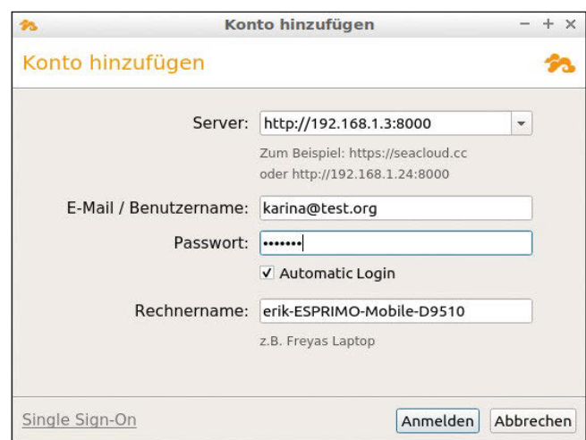
3 Der Seafile-Client meldet sich über einen einfachen Dialog am Syncwerk-Server an. IP-Adresse, Port und Login genügen.
