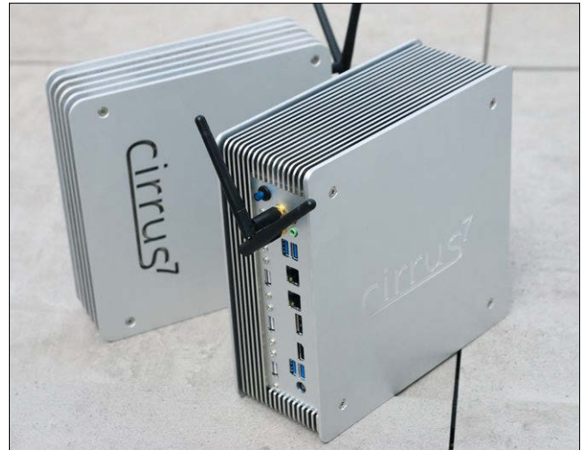
3 Der Nimbus v2 bietet je vier Ports mit USB 3.1 und USB 2.0, zwei Ethernet-Ports sowie HDMI und DisplayPort 1.2.
