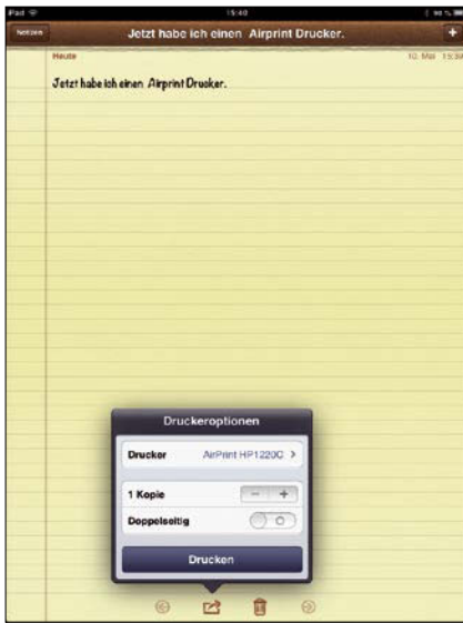
3 Drucken vom iPad – dank Cups und Avahi nutzen Sie dabei jeden Rechner am Linux-PC, ganz ohne Konfiguration.
