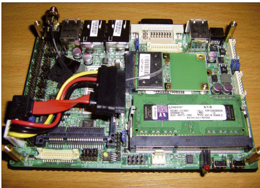
2 Die kompakten Maße des Jetway-PCs lassen zwar kaum Raum zum Manövrieren, aber eine WLAN-Karte mit Mini-PCIe-Anschluss fand im Testsystem dennoch Platz.
