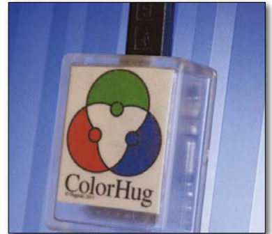
Die Software, Firmware und Hardware des preiswerten Colorimeters Colorhug sind quelloffen. (Bild: Richard Hughes)
