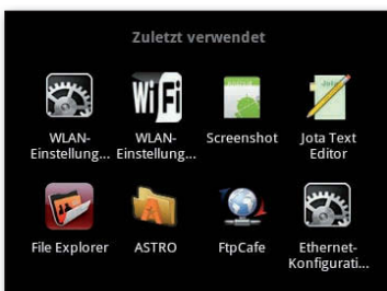
3 Beidhändiger Taskwechsel: Mit links hält man die Home-Taste gedrückt, mit rechts wählt man über die Pfeiltasten im Taskswitcher das Gewünschte aus.
