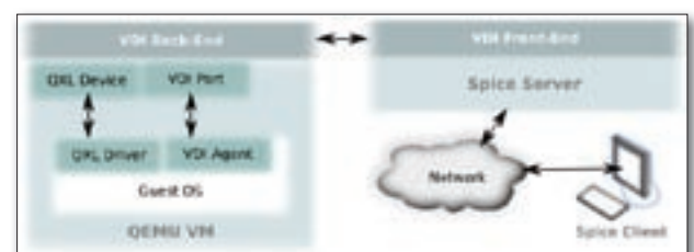
3 Schematischer Aufbau des neuen Simple Protocol for Independent Computing Environments aus Fedora 14.
