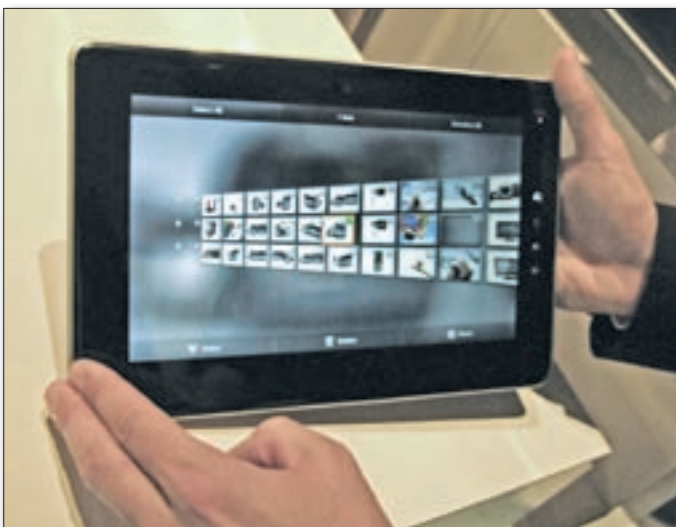
4 Das Toshiba Folio 100 besticht durch gute Grafikleistung und 1-GHz-Dualcore-CPU dank Nvidia Tegra 250.
